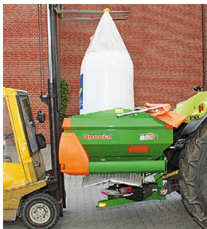
Remplissage avec des big-bags
