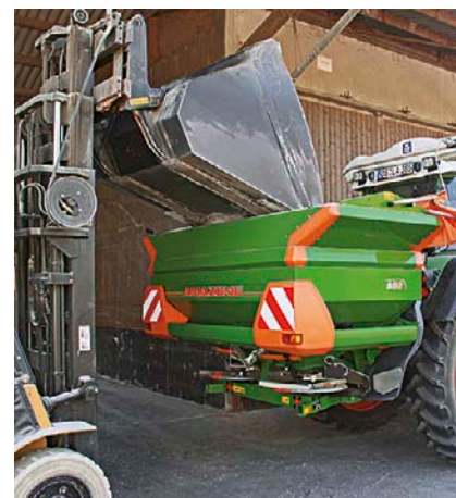
Remplissage avec le godet d'un chargeur frontal
